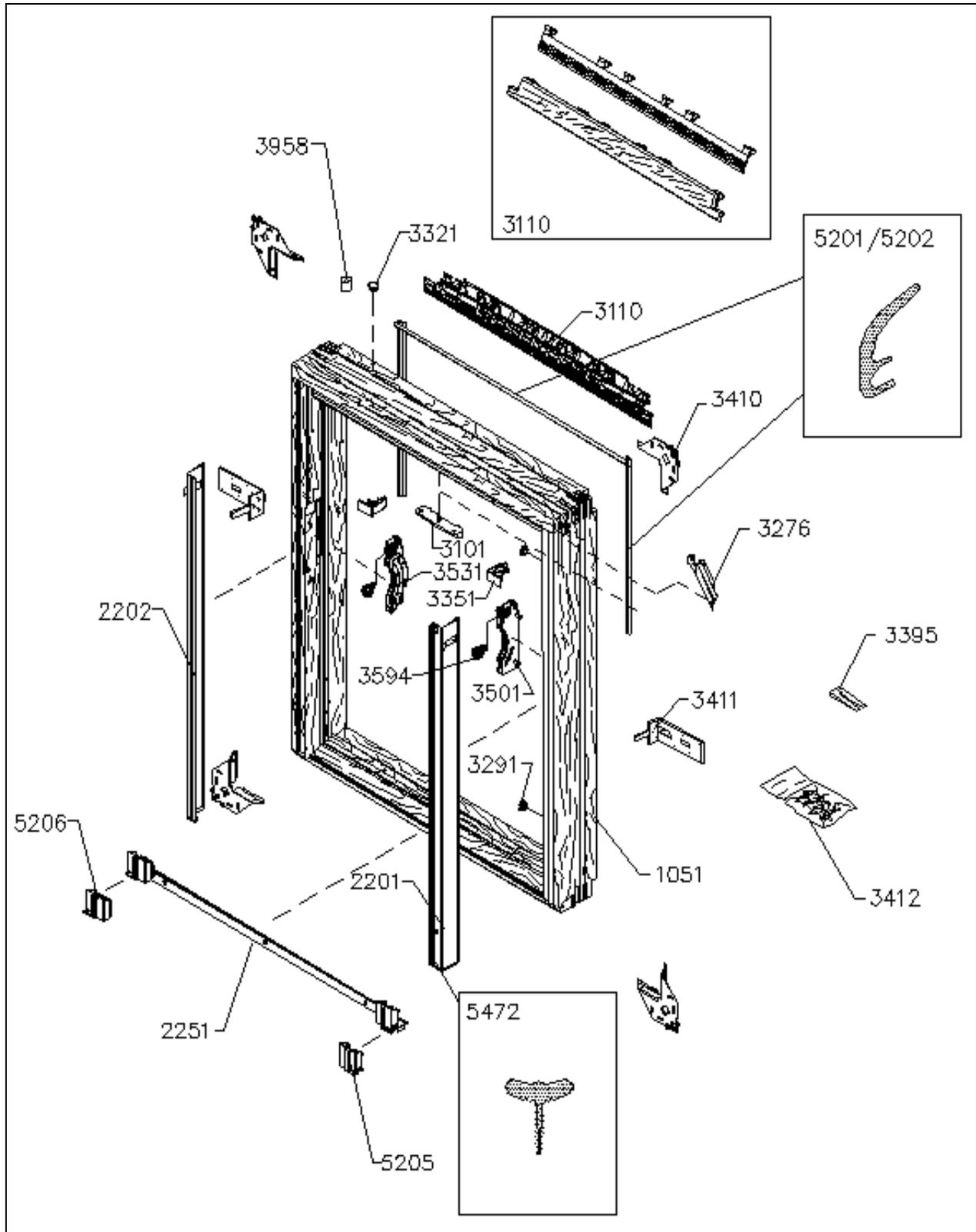
Flügel komplett, Markisenkasten, Lüftungsklappe mit Griffleiste
