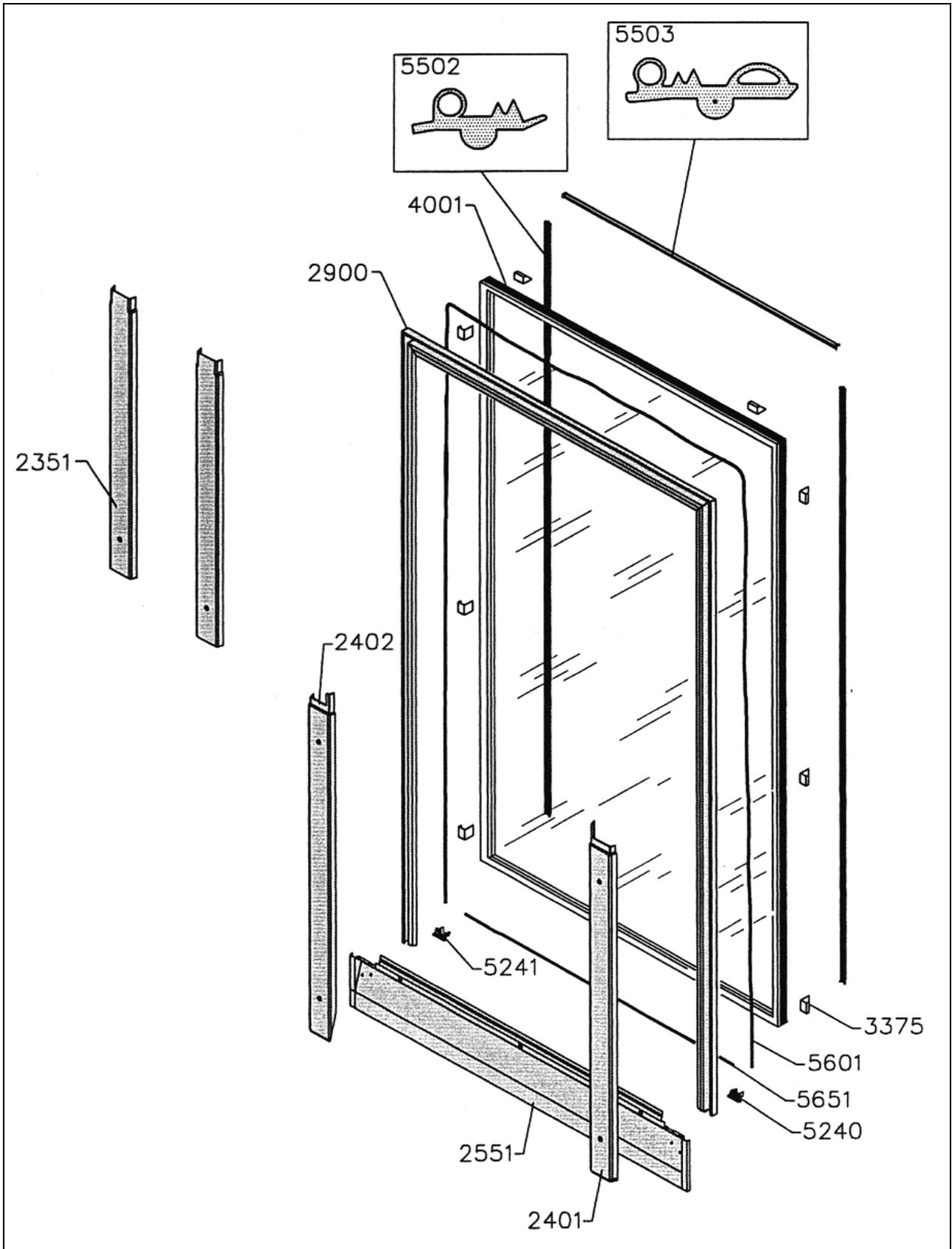
Packstück 1 (Obenelement): Zwischenrahmen, Federstangen, Federabdeckung, Dichtungen, Kleinteile
