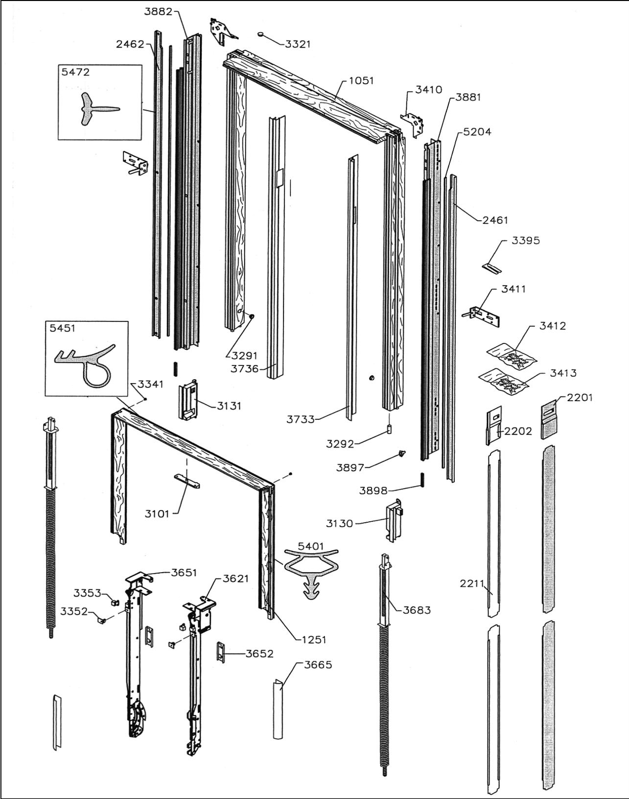
Packstück 2 (Untenelement): Flügel, Blendrahmen, Abdeckbleche, Dichtungen, Kleinteile (Grafik im Querformat)
