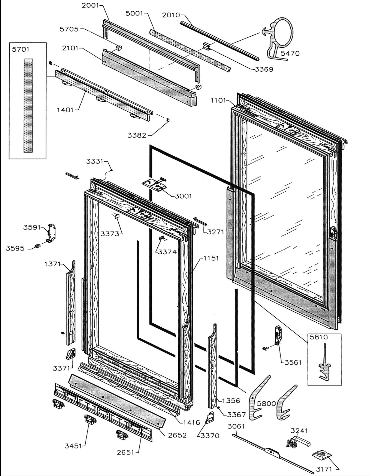
Packstück 1 (Obenelement): Verglasung, Verglasungsdichtungen, Abdeckbleche, Kleinteile
