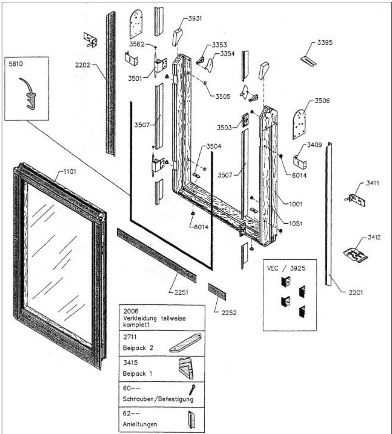
Untenelemente VEA/B/C: Flügel, Verglasung, Verglasungsdichtungen, Abdeckbleche, Verschluss-mechanismus
