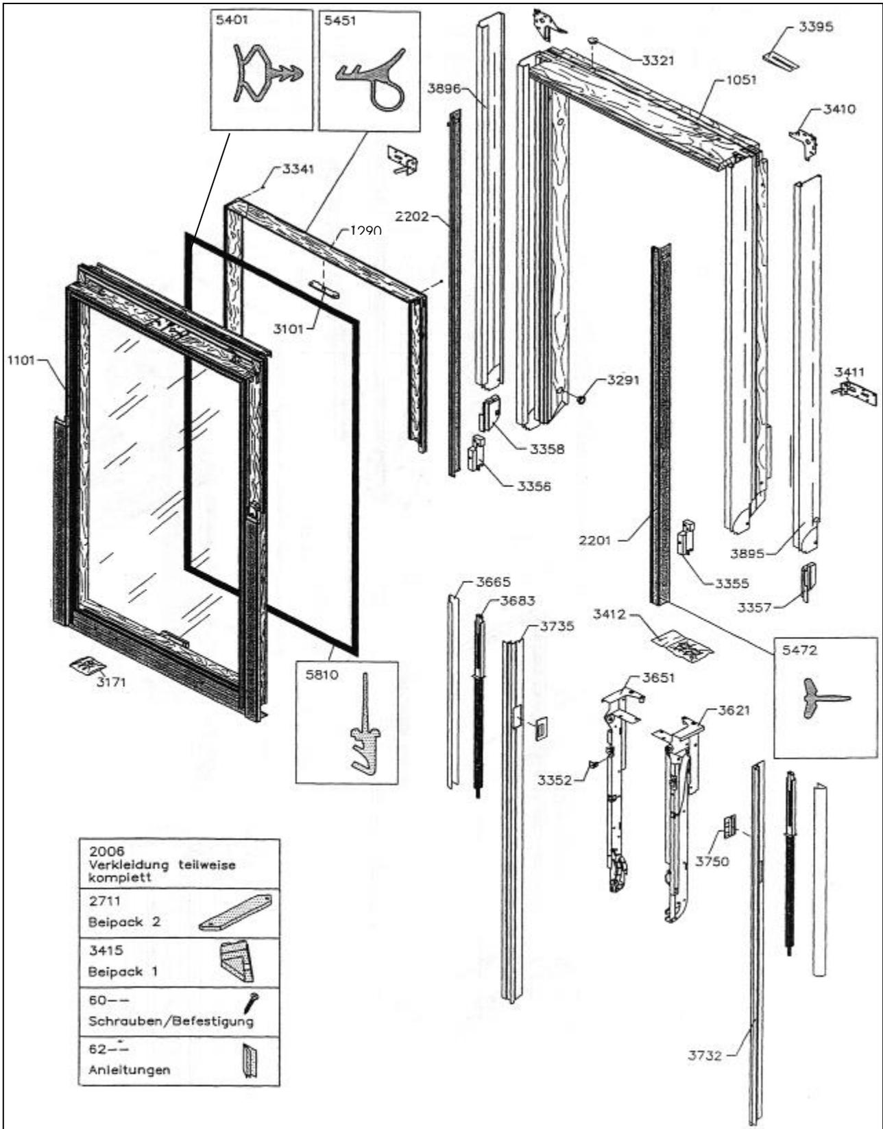
Obenelement GEL: Verglasung, Verglasungsdichtung, Beschläge, Abdeckbleche, Kleinteile
