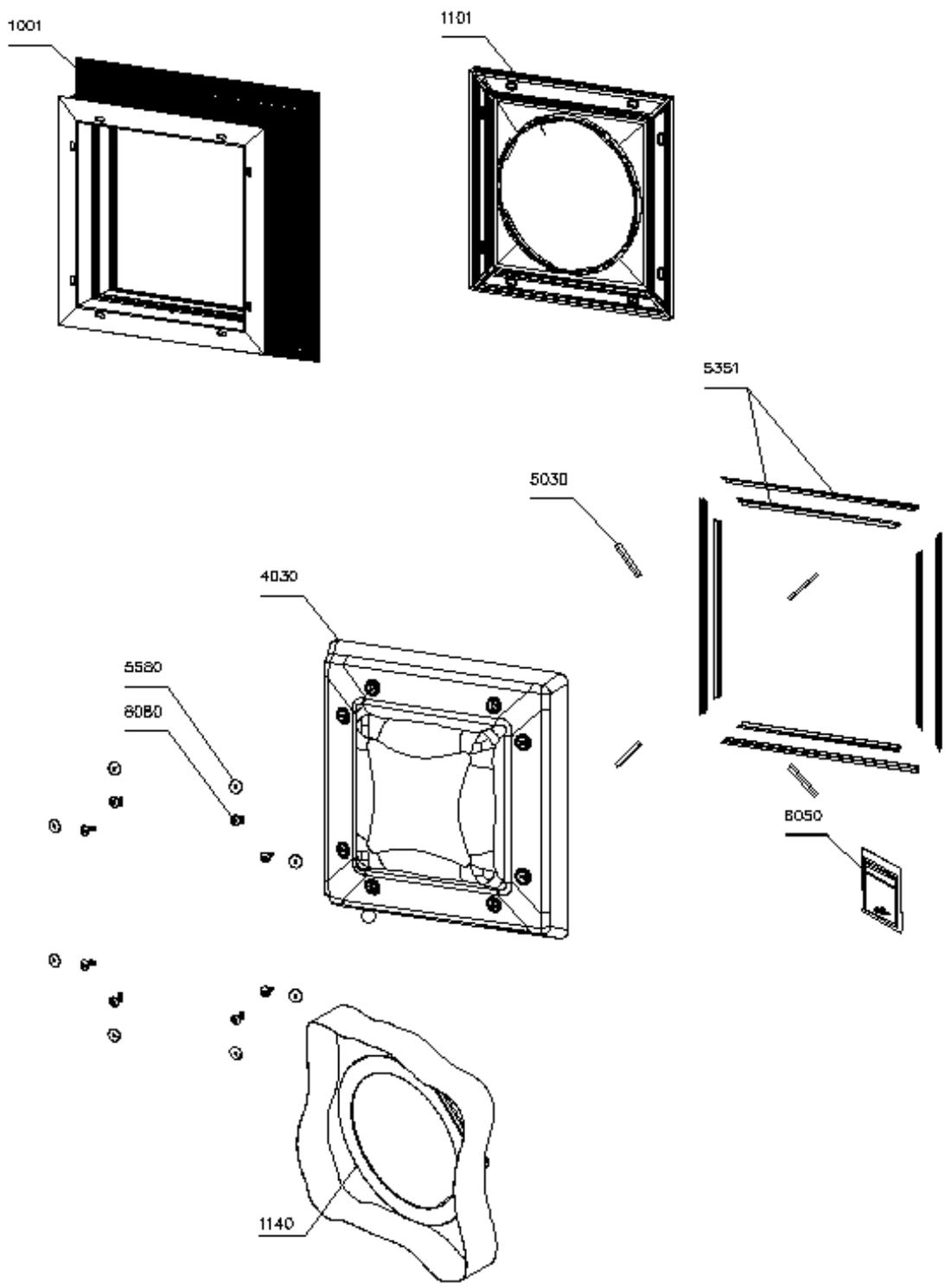
**Tageslicht-Spot mit starrem Lichtrohr**
